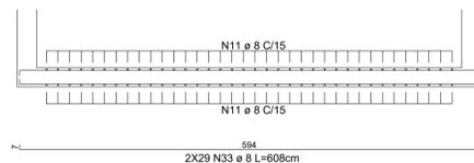
LAJE - ARMADURAS - CORTE LONGITUDINAL
