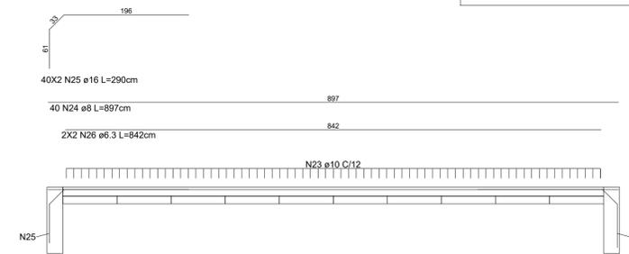
LAJE - ARMADURAS - CORTE NO APOIO
