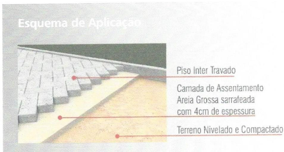
**Preparo do terreno:** para a aplicação do pavimento **intertravado**, o terreno deve ser compactado vigorosamente e nivelado, definindo nesta etapa, os planos de caimento que se deseja da pavimentação para evitar afundamentos após o assentamento do piso intertravado.
