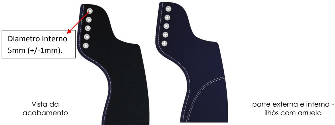
**10- BIQUEIRA, SOBREBIQUEIRA, BANDA LATERAL** Devem ser uma Composição elastomérica vulcanizada, composta por borracha natural (NR), borracha de butadieno estireno (SBR) e borracha de etileno propileno dieno (EPDM), sendo estes componentes preponderantes. Biqueira e sobre - biqueira com espessura mínima de 1,2 mm, sendo que a biqueira deve ter gravações conforme a ilustração abaixo que melhoram a resistência frontal do produto.
